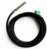
Используйте температурный датчик для более правильной температурной компенсации аккумулятора. Датчик крепится непосредственно на корпус аккумулятора. Длина кабеля составляет 3 метра. Подключается в соответствующий терминал контроллера, обозначенный под номером ③.
