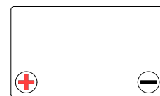
Расположение клемм D
