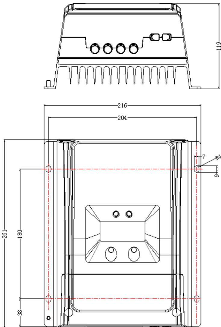
Tracer6210/6415/6420AN Размеры (Единица измерения: мм)
