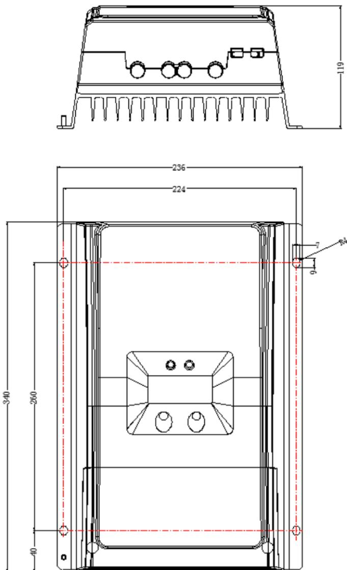
Tracer8415/8420AN Размеры (Единица измерения: мм)
