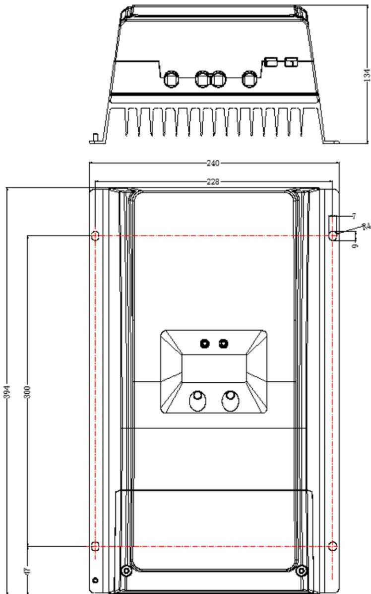
Tracer10415/10420AN Размеры (Единица измерения: мм)
